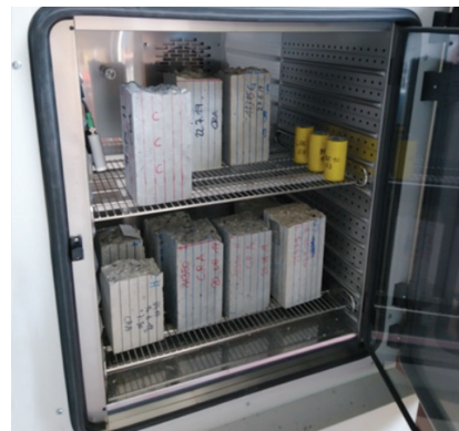
Klimatska komora sa prizmama za ubranu karbonizaciju (švajcarski SIA 262/1-X standard)
